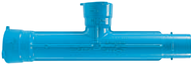
B-Stück, Best.-Nr. 537 (Montage Unterflurhydrant oder Be- und Entlüftungsgarnitur in der Strecke ohne Rohrschnitt) Nennweiten: DN 100/80, DN 150/80, DN 200/80
