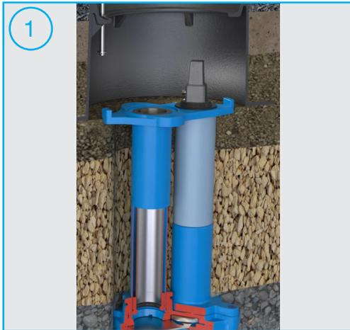
1 Demontage der Klauenkupplung, sowie Montage des Abdichtrohrs
