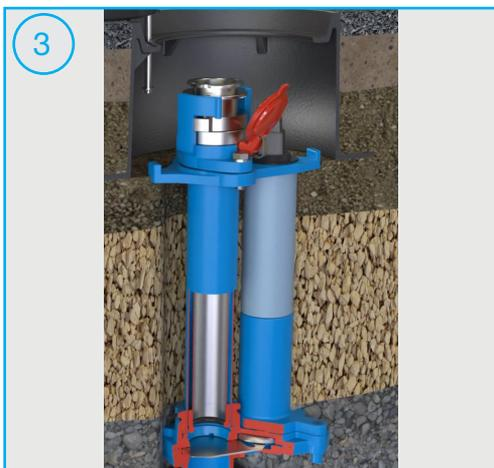
3 Aufsetzen und Verspannen des Abdruckflansches
