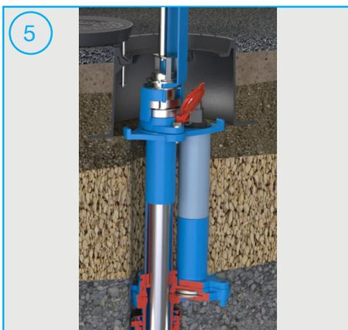
5 Aufsetzen des Einführwerkzeugs, anschließend den UFH unter vollem Betriebsdruck öffnen und finales Positionieren des Sensors in die Rohrleitung
