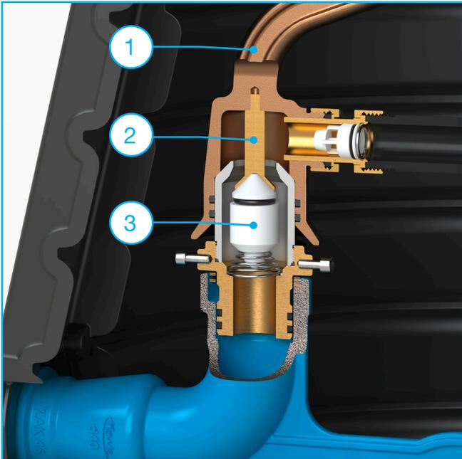
Die Zählergarnitur (1) drückt während der Montage mit Hilfe des Druckstößels (2) den Dichtkegel (3) auf, wodurch der Wasserdurchfluss hergestellt wird. Während der Montage ist eine vollständige Abdichtung der Verbindung gesichert.
