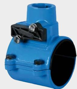
Anbohrschellen mit Hilfsabspernung: hilfsweises Absperrn mit Hilfe einer Steckscheibe aus nichtrostendem Stahl, Anbohrung seitlich oder von oben möglich
