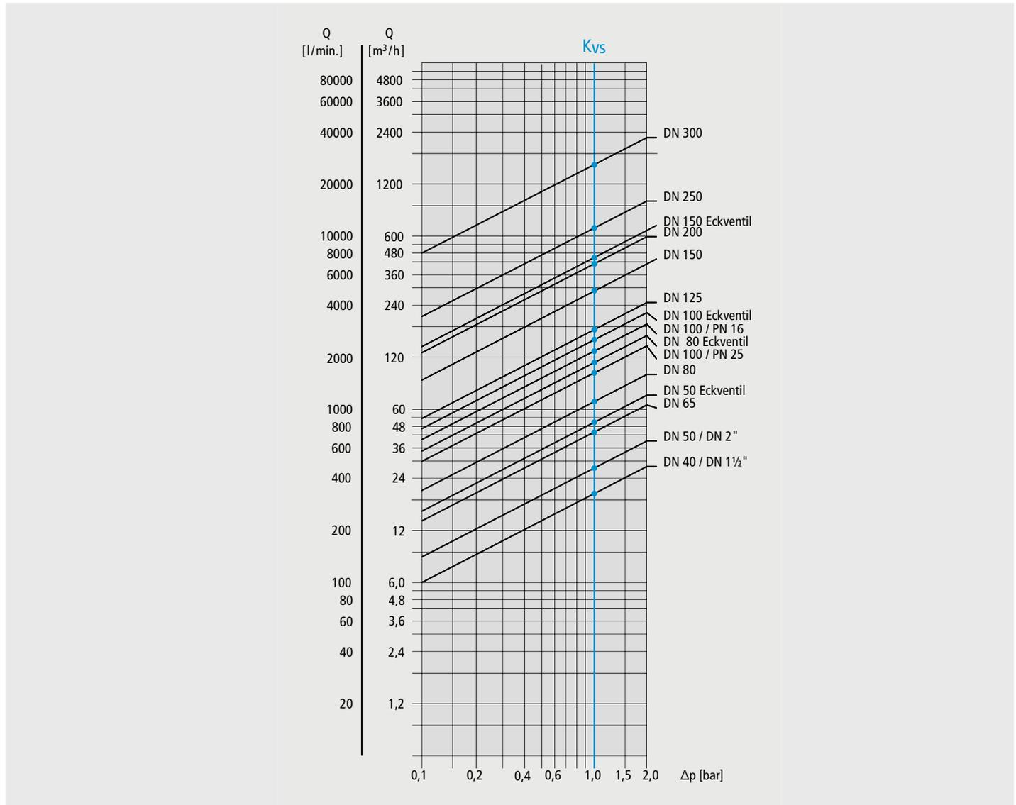
Durchfluss-Leistungsfaktor Kvs in  $m^3/h$  und  $l/min$  bei  $\Delta p = 1$  bar
