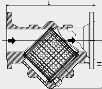
Schmutzfänger sind für den Einbau in waagerechte Rohrleitungen konzipiert. Dabei ist zu beachten, dass der Deckel in Fließrichtung gesehen, auf der rechten Seite installiert wird. Ein Einbau in schrägen und senkrechten Rohrleitungen ist dann zulässig, wenn die Fließrichtung von oben nach unten erfolgt (Pfeilrichtung am Gehäuse beachten).
