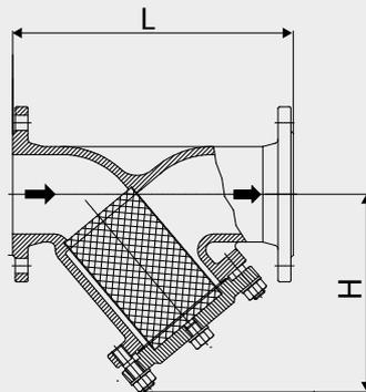
Schmutzfänger sind für den Einbau in waagerechte Rohrleitungen konzipiert. Ein Einbau in schrägen und senkrechten Rohrleitungen ist dann zulässig, wenn die Fließrichtung von oben nach unten erfolgt (Pfeilrichtung am Gehäuse beachten).
