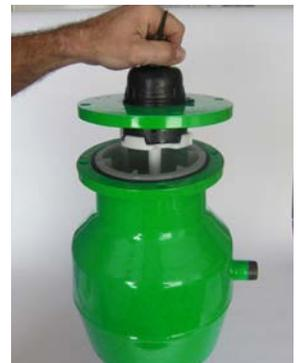
5.2.9 Sicherungsring auf der Flanschoberseite mit geeignetem Werkzeug entriegeln und Flansch nach oben abziehen.
