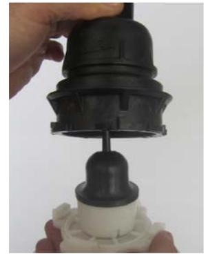
5.2.12 Rollmembrane an der Gumminippel herausstülpen und auf Ablagerungen und mechanische Beschädigungen prüfen. Ablagerungen durch Abwischen mit feuchtem Tuch entfernen. Sollte ein Tausch der Membrane erforderlich sein, Membrane aus Haltenut trennen und durch neue Membrane ersetzen.
