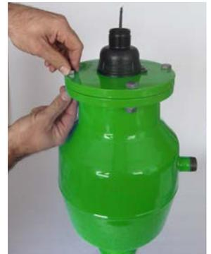
5.2.8 Flansch mit komplettem Ventilmechanismus nach oben aus dem Gehäuse herausziehen und aufrecht auf feste Unterlage stellen.
