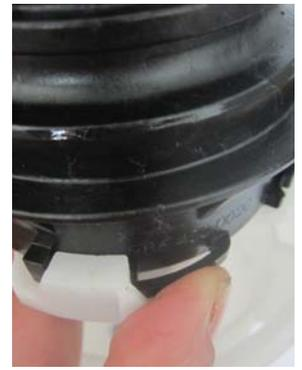
5.2.11 Schlitzte des Ventilkorb reinigen und durchspülen.
