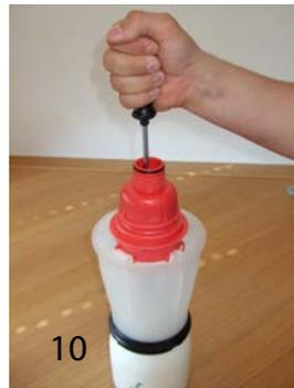
11. Siebscheibe durch eindringen der beiden Sicherungshaken entriegeln, durch Linksdrehung vom „BEV-Kopf“ lösen und diesen nach oben abziehen.
