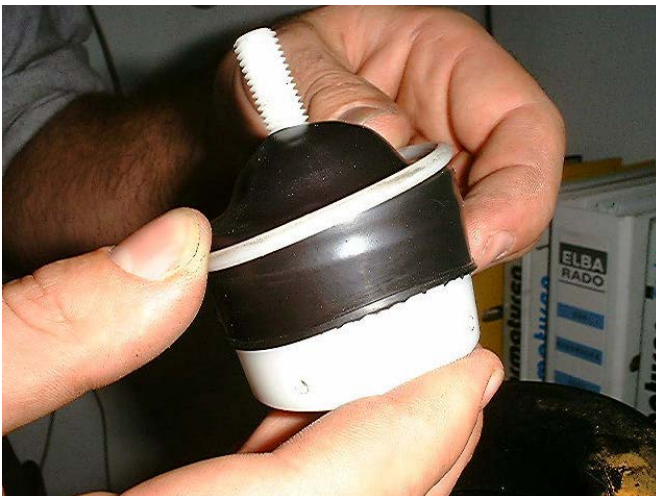
8. Vorgewärmten Ring (3 Min. in ca. 50° C warmes Wasser) aufschieben.
