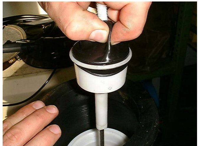
9. Membrane durch Zurückziehen bis zum angeformten Wulst zentrieren und in den Ventilköcher stülpen.
