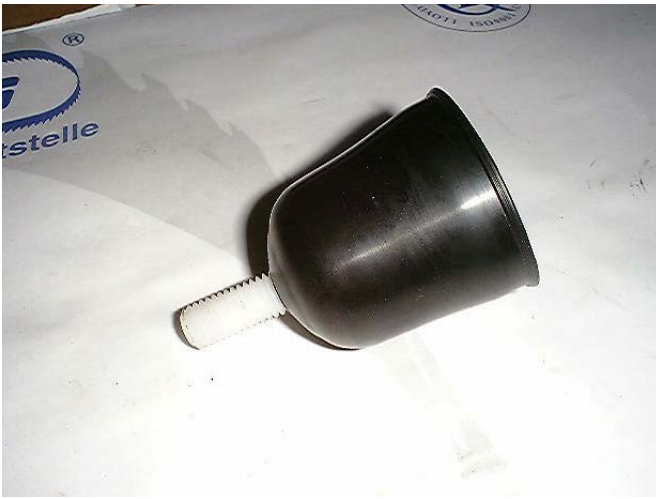
6. Membrane komplett umstülpen.
