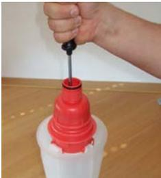
5. Siebscheibe durch eindrücken der beiden Sicherungshaken entriegeln, durch Linksdrehung vom „BEV-Kopf“ lösen und diesen nach oben abziehen.
