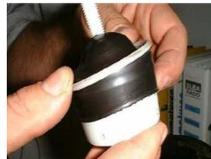
11. Membrane durch Zurückziehen bis zum angeformten Wulst zentrieren und in den Ventilköcher stülpen.
