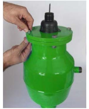
5.2 Flansch mit komplettem Ventilmechanismus nach oben aus dem Gehäuse herausziehen und aufrecht auf feste Unterlage stellen.
