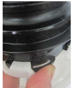
5.5 Schlitzte des Ventilkorbes reinigen und durchspülen.
