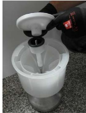
5.6 Rollmembrane durch Anziehen an der Edelstahlschraube herausstülpen und auf Ablagerungen und mechanische Beschädigungen prüfen. Ablagerungen durch Abwischen mit feuchtem Tuch entfernen. Sollte ein Tausch der Membrane erforderlich sein, Membrane aus Haltenut trennen und durch neue Membran ersetzen. Oben liegenden Dichtring ebenfalls auf Ablagerungen und mechanische Beschädigung prüfen. Gegebenenfalls mit feuchtem Tuch reinigen oder ersetzen.
