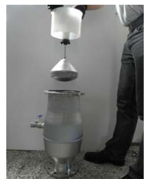
5.4 Führungsstange abschrauben und Schraube bei gleichzeitigem Anheben des Ventiltellers herausdrücken. Ventilteller abnehmen.
