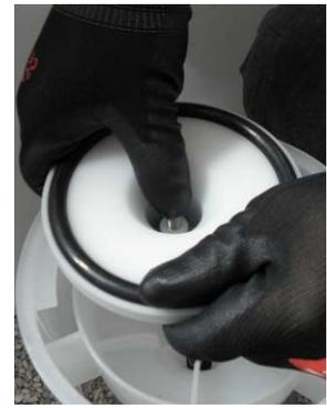
5.5 Schlitz des Korbes am Ventilteller reinigen und durchspülen.
