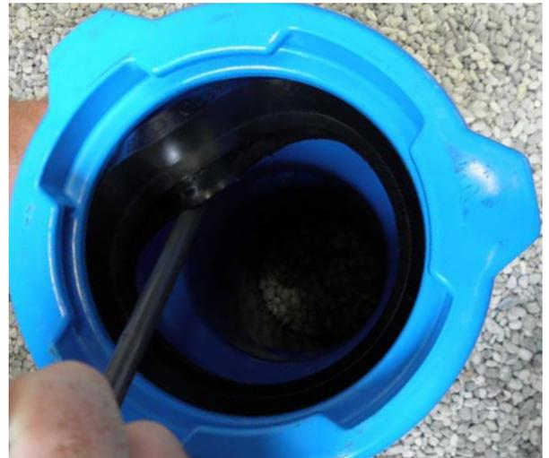
Dichtung mit dem eingehakten Demontagewerkzeug aus dem Dichtsitz heben.
