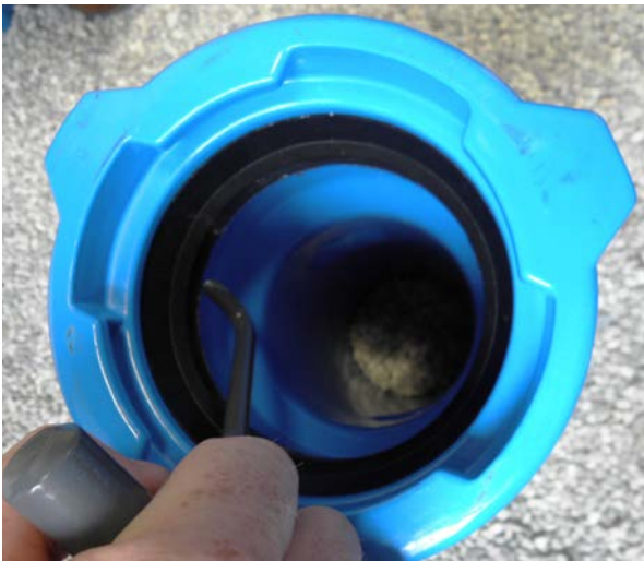
Demontagehaken hinter der Dichtung ganz einhaken.
