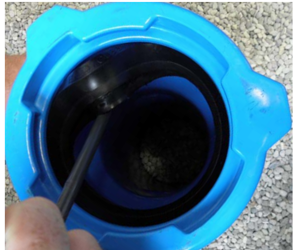
Dichtung mit dem eingehakten Demontagewerkzeug aus dem Dichtsitz heben.
