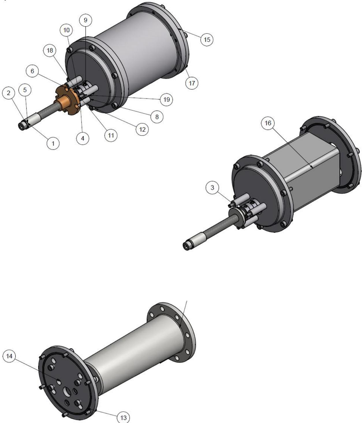
Die Druckschraube, Druckmutter und die Fiberscheiben sind geschmiert für eine lange Laufzeit und müssen nicht demontiert werden. Eine Demontage der Kupplung und der Druckschraube haben eventuell ein Neueinstellen der Endanschläge zur Folge.
