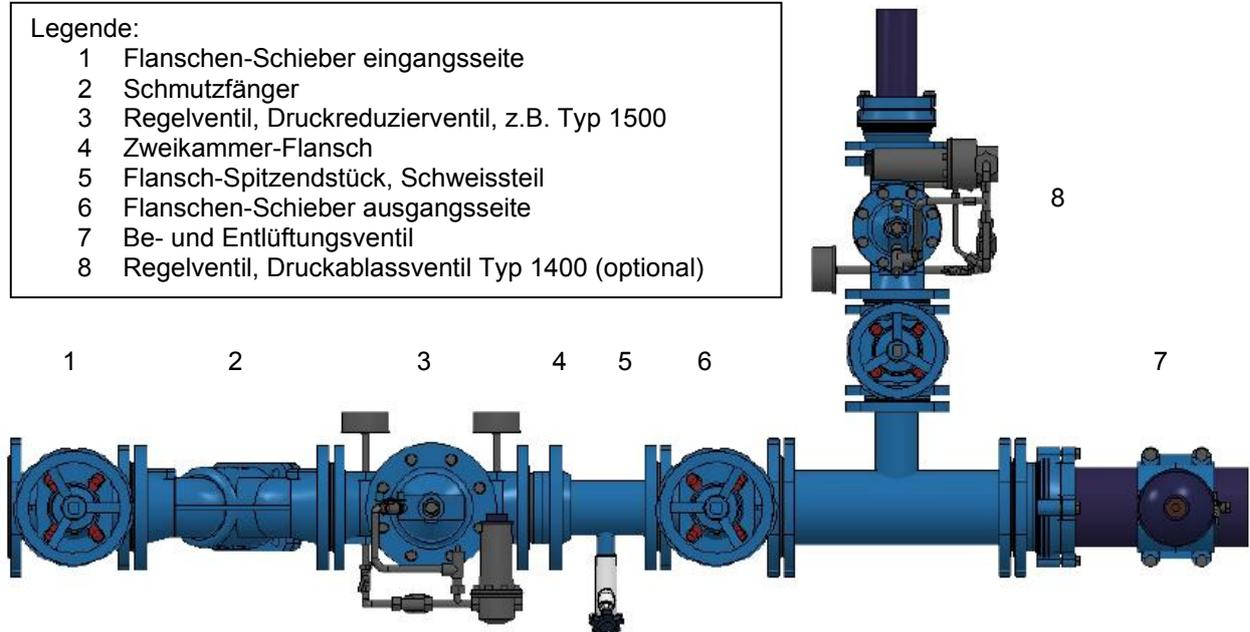
Das HAWIDO muss waagrecht, (andere Bauarten auf Anfrage) mit dem Ventildeckel nach oben, eingebaut werden. Wir empfehlen, einen Absperrschieber und einen Schmutzfänger vor dem Ventil sowie einen Absperrschieber am Ausgang zu montieren.
