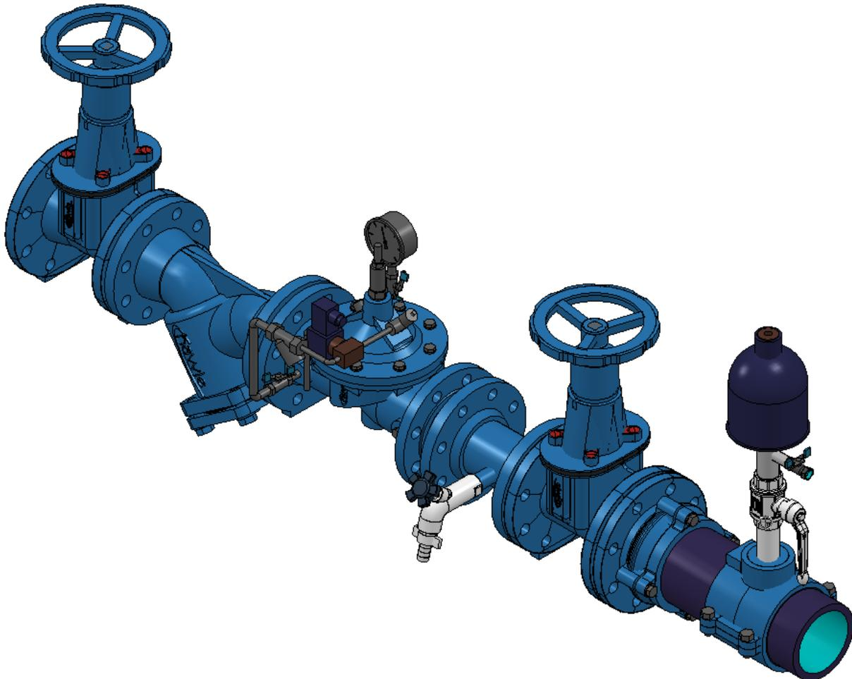
Das HAWIDO muss waagrecht, (andere Bauarten auf Anfrage) mit dem Ventildeckel nach oben, eingebaut werden. Wir empfehlen, einen Absperrschieber und einen Schmutzfänger vor dem Ventil sowie einen Absperrschieber am Ausgang zu montieren.
