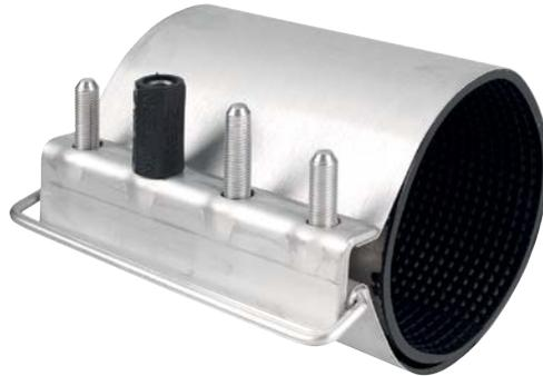
Reparaturschelle mit selbstzentrierendem Verschluss-System für Guss-, Stahl-, PVC- und AZ-Rohre. Die mit der Spannbrücke verschweißten Schrauben erlauben mit Hilfe des Montagebügels ein einfaches Zusammenfügen. Zur Erleichterung der Montage ist der mittlere Gewindebolzen ab d 87 mm verlängert. Die Muttern können einfach und zeitsparend aus dem beigegebenen Muttermagazin aufgeschraubt werden.
