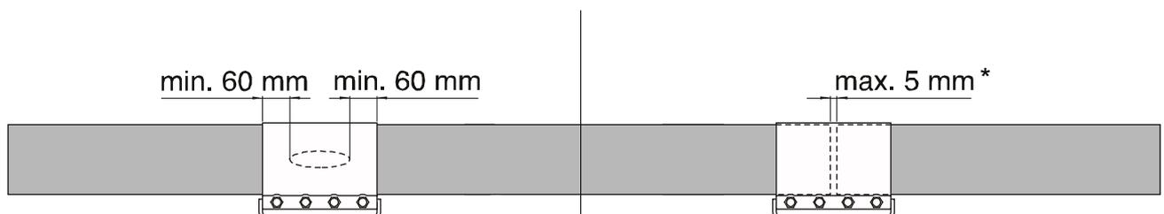
Wegen der Rohrstabilität, sollte der Durchmesser der Beschädigung 40% des Rohrdurchmessers nicht überschreiten!
