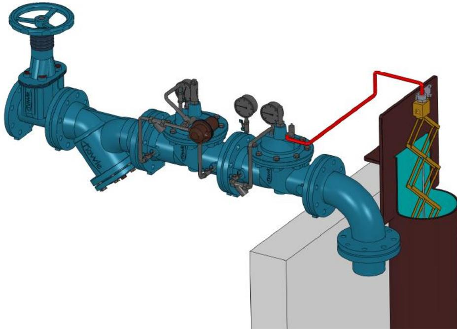
Das HAWIDO muss waagrecht, (andere Einbauarten auf Anfrage) mit dem Ventildeckel nach oben, eingebaut werden. Wir empfehlen, einen Absperrschieber und einen Schmutzfänger vor dem Ventil zu montieren. Je nach Leitungsführung (z.B. Leitung führt nach oben) ist auch nach dem Ventil ein Absperrschieber einzuplanen. Vor der Inbetriebnahme muss geprüft werden, dass kein grober Fremdkörper ins HAWIDO eindringen kann.
