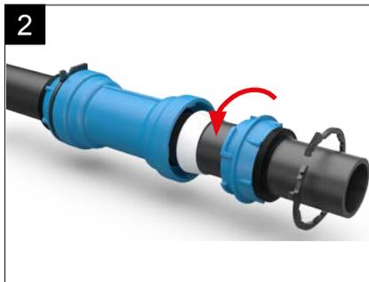
Sicherungsring entfernen. Konusring ( blauer Gussring ) mit Verriegelungsschlüssel Best.Nr. 609-00 abschrauben.
