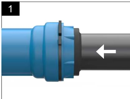
Fitting oder Rohr in Montagerichtung entlasten ( kurzer Ruck )!
