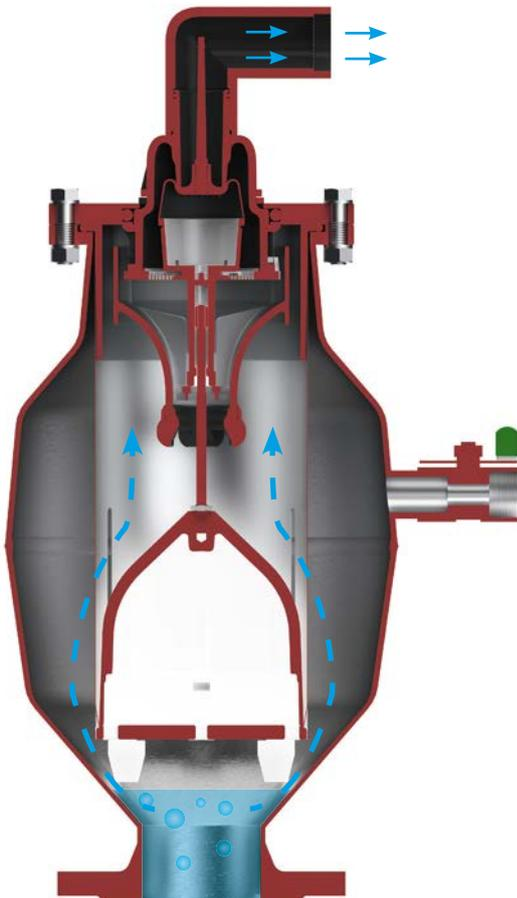
Abb.: Ventil offen - Entlüftungsvorgang
