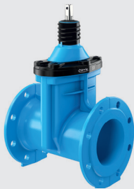
471-00 Keil-Oval-Schieber „E3“, PN 25, Baulänge Grundreihe 15
