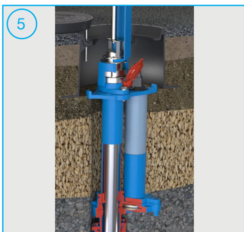
Aufsetzen des Einführwerkzeugs, anschließend den UFH unter vollem Betriebsdruck öffnen und finales Positionieren des Sensors in die Rohrleitung
