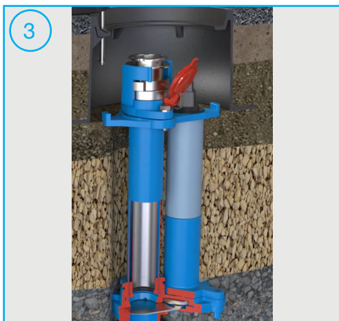
Aufsetzen und Verspannen des Abdruckflansches
