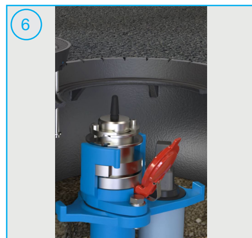
Montage der Sicherungsbleche sowie der Antenne
