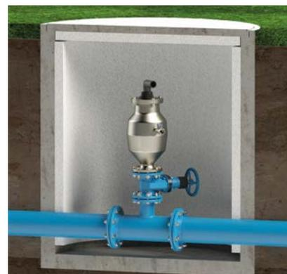
Ein BEV im Schachteinbau wird durch eine Auskleidung der Schachtwände und des Schachtdeckels mit Isoliermaterial vor Frost geschützt (siehe Abbildung).
