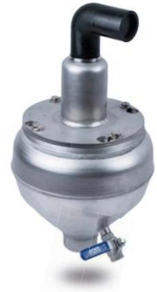
Das Be- und Entlüftungsventil aus nichtrostendem Stahl mit einzigartiger Rollmembran-Technik ist für die Entlüftung großer Luftmengen unter Betriebsdruck bestens geeignet. Der Dichtsitz kommt nicht in Kontakt mit dem Medium. Das BEV arbeitet stufenlos von 0 bis 10 bar und dichtet selbst im drucklosen Zustand einwandfrei ab. Das Dichtprinzip mit Rollmembran hat zudem eine druckstoßdämpfende Eigenschaft.
