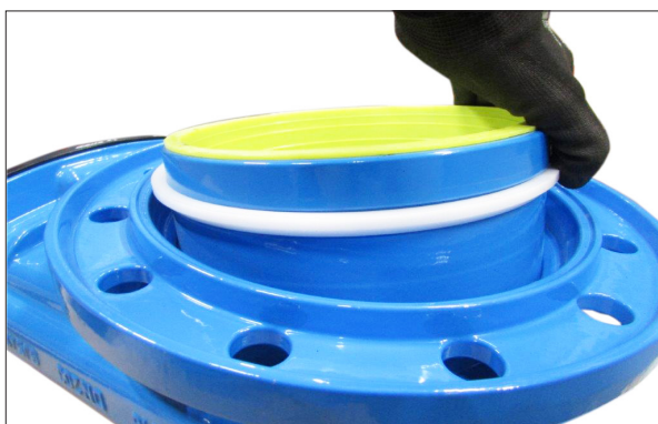
5. Sicherungsring montieren Achtung: Der Sicherungsring aus POM hat eine Schräge in der Kontur, die zum Flansch zeigen muss. Der Sicherungsring muss in der vorgesehenen Nut liegen.
