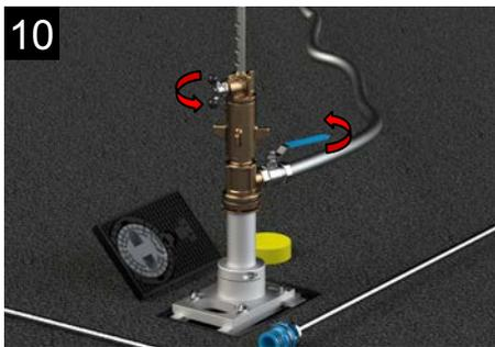
Bohrstange durch Festziehen der Klemmschraube fixieren. Spülschlauch an das Anbohrgerät montieren und Spülhahn in Offenstellung bringen.
