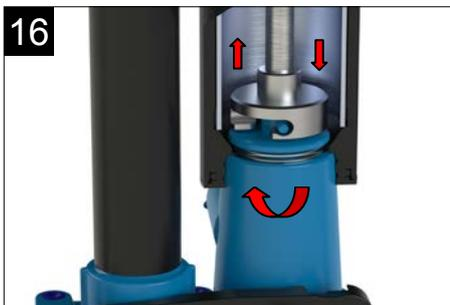
ZAK-Stopfen mit Schlüssel in die Hawlinger-Muffe einschieben, nach unten drücken und rechtsdrehend (90°) verriegeln. Anschließend Entriegelungssicherung durch Hochziehen des Schlüssels herstellen.
