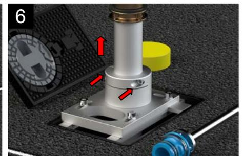
6 Anbohrrohr gegen unbeabsichtigtes Entriegeln nach oben ziehen und durch Festziehen der Innensechskantschrauben (M8) festklemmen.
