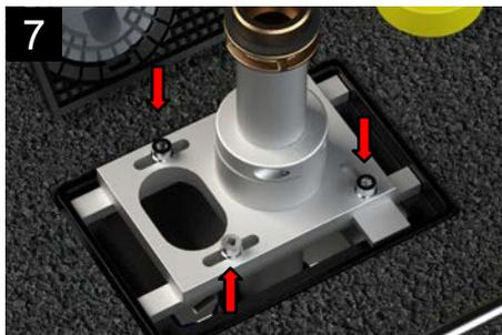
7 Lage der Spanneinheit durch Festziehen der Innensechskantschrauben (M10) sichern.
