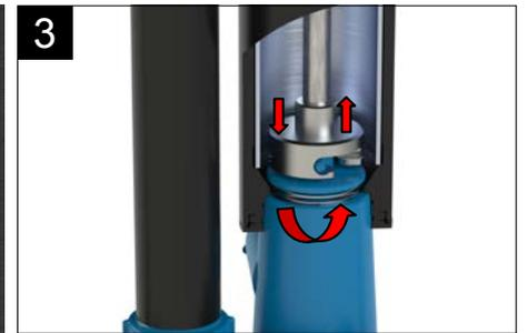
3 Schlüssel gegen den Widerstand von Feder und Reibung kräftig nach unten drücken. Dann bis Anschlag nach links drehen und den Stopfen herausziehen.
