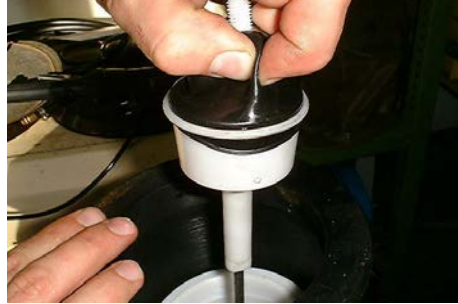
17. Membrane durch Zurückziehen bis zum angeformten Wulst zentrieren und in den Ventilkörper stülpen.
