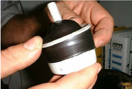
16. Vorgewärmten Ring (3 Min. in ca. 50° C warmes Wasser) aufschieben.
