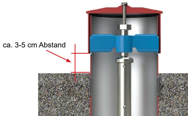
Der Einbau eines Sickerelements Best.Nr. 992-03 oder alternativ Sickerschlauchs Best.Nr. 992-04 in Verbindung mit sickerfähiger Verfüllung wird empfohlen.
