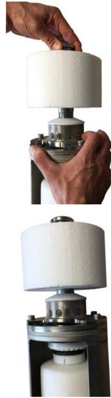
**Achtung:** Bei BEG mit Rd 1,0 und Sonderfunktion "nur Be- oder nur Entlüftung" kann die Frostschutzscheibe **nicht** montiert werden!
