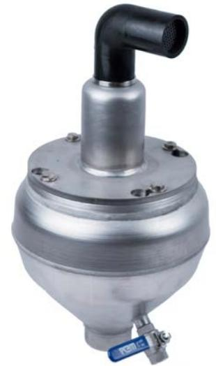
Das Hawle Be- und Entlüftungsventil Best.Nr. 989 mit verringerter Einbauhöhe ist zum Be- und Entlüften von Abwasserdruckleitungen verwendbar. Das Be- und Entlüftungsventil arbeitet stufenlos von 0 bis 10 bar und dichtet selbst im drucklosen Zustand einwandfrei ab.
