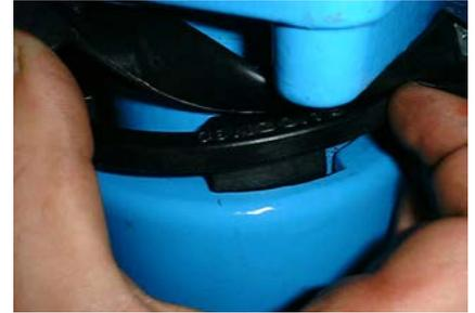
Zur Sicherung der Drehmuffe wird in den Spalt zwischen Gehäuse und Muffe die mitgelieferte Verdrehsicherung DN80 montiert. Bei Bedarf den Spalt durch Anheben der Muffe vergrößern. Im Gehäuse und in der Muffe sind Aussparungen angebracht. In diese Aussparungen wird nun die Verdrehsicherung eingesetzt. Achtung: Beschichtung nicht beschädigen!
