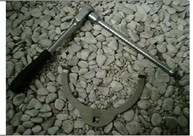
Wird in die Muffe ein Hydrant DN 80 mit Spitzende eingebaut, muss die Muffe in eine 45° Position gedreht werden. Danach wird der Hydrant eingesetzt. Zum Verriegeln der Muffe wird das Verdrehwerkzeug auf die seitlichen Bolzen aufgesetzt und mit der Ratsche die Muffe gegen den Uhrzeigersinn gedreht, bis der Hydrant verriegelt ist. Gegen unbeabsichtigtes Verdrehen und Verschmutzungen muss die mitgelieferte Verdrehsicherung und Schmutzkappe montiert werden.
