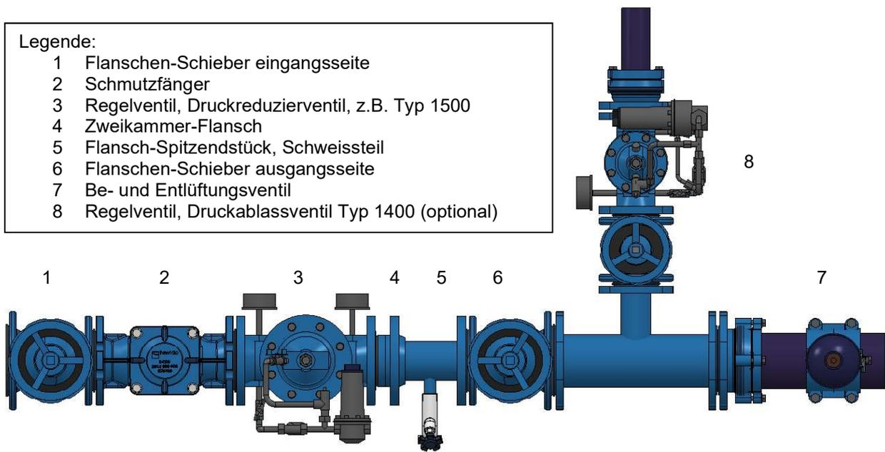
Das HAWIDO muss waagrecht, (andere Bauarten auf Anfrage) mit dem Ventildeckel nach oben, eingebaut werden. Wir empfehlen, einen Absperrschieber und einen Schmutzfänger vor dem Ventil sowie einen Absperrschieber am Ausgang zu montieren.
