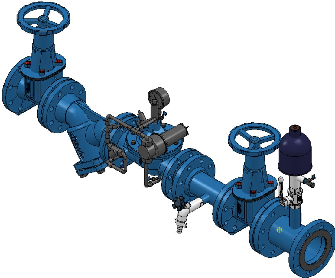
Das HAWIDO muss waagrecht, (andere Bauarten auf Anfrage) mit dem Ventildeckel nach oben, eingebaut werden. Wir empfehlen, einen Absperrschieber und einen Schmutzfänger vor dem Ventil sowie einen Absperrschieber am Ausgang zu montieren.
