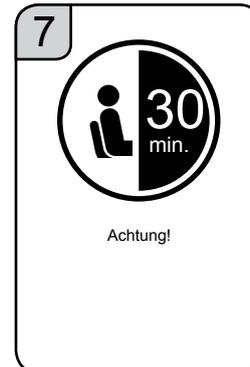
Schrauben nach 30 Minuten bzw. nach erfolgter Druckprüfung nachziehen.
