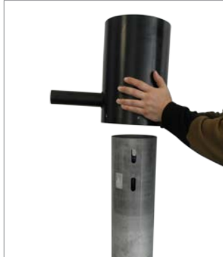
6. Handelsübliches Gleitmittel auf innenliegende Dichtung auftragen. Überflutungssicherung ohne Deckel auf Standrohr aufsetzen.
