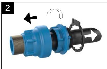
Sicherungsring entfernen. Konusbereich (blauer Gussring) mit geeignetem Werkzeug abschrauben (entweder Rohr- zange oder Drehschlüssel)
