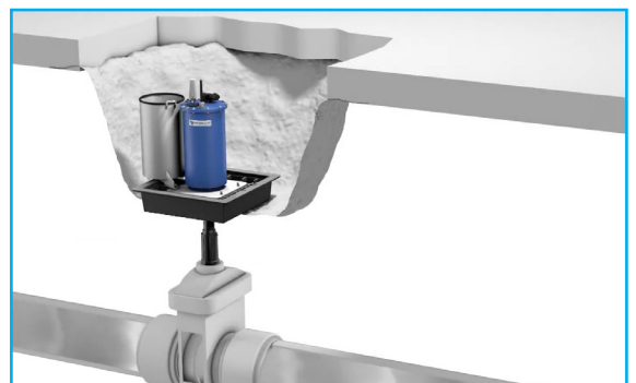
Antrieb und Akkugehäuse auf der Trageplatte fixieren
