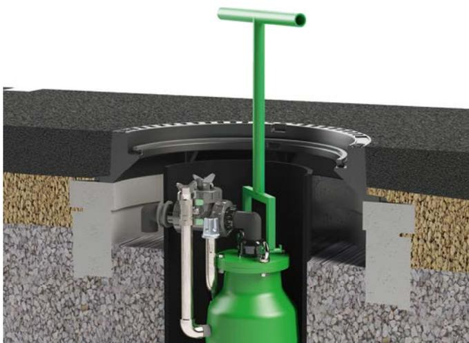
Für die Wartung kann das Be- und Entlüftungsventil nach dem Absperren mit der Ventilaushebevorrichtung 985-08 entnommen werden.
