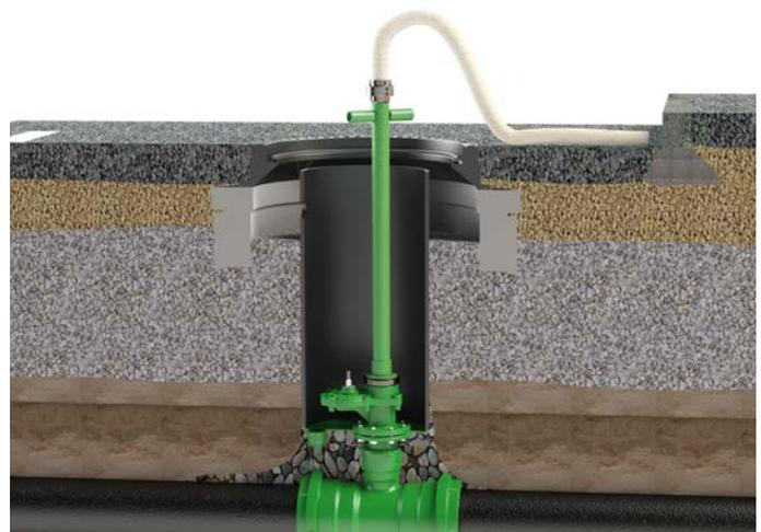
Die Spül- und Entnahmegarnitur 985-03 ermöglicht ein einfaches Spülen der Abwasser-Druckleitung. Mögliche Ablagerungen können beseitigt oder abgesaugt werden.
