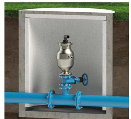
Ein BEV im Schachteinbau wird durch eine Auskleidung der Schachtwände und des Schachtdeckels mit Isoliermaterial vor Frost geschützt (siehe Abbildung). Freistehende BEVs, z. B. unter Brücken, müssen frostsicher isoliert werden, z. B. mit einem Isoliermantel. Zur Ableitung von Spritzwasser muss ein Drainagerohr vom BEV ins Freie führen.
