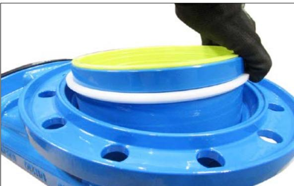
5. Sicherungsring montieren
