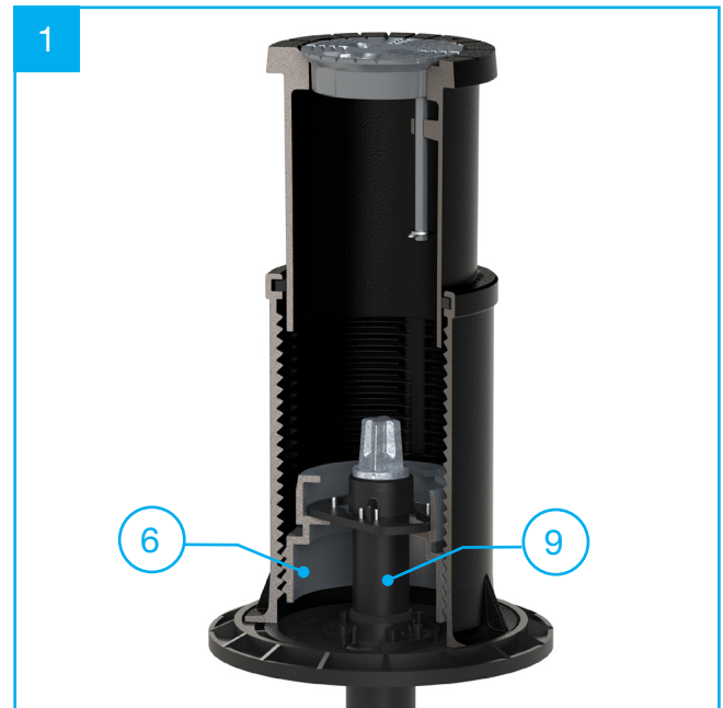
Abbildung: Einbaugarnitur (9) ist eingehängt, Gewinding (6) ist unten
