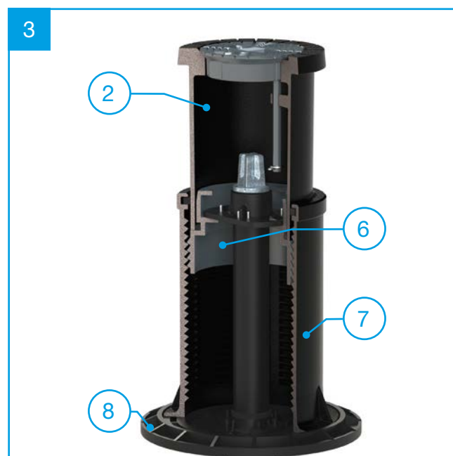
Abbildung: Gewinding (6) ist oben, die formschlüssige Verbindung mit Gewinding (6) und Ziehring (2) ist hergestellt und ermöglicht somit den Lastabtrag über die Grundkappe (7) bzw. Tragplatte (8).
