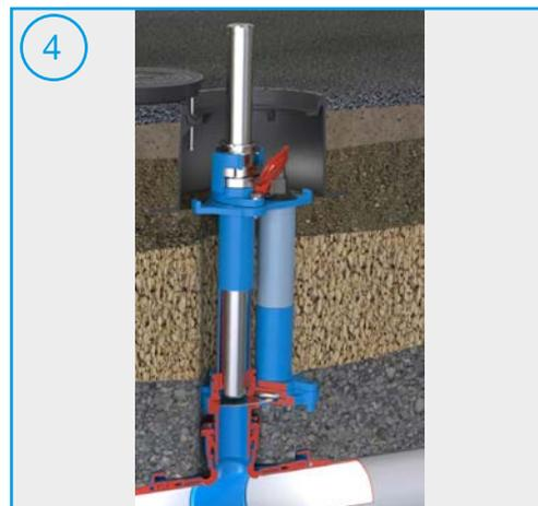
4 Einführen der Sonde durch die unten liegende Dichtung bis kurz vor die Absperrscheibe
